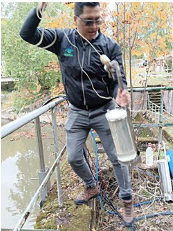
*Experimento de muestreo de agua con el muestreador de Limnos. Foto por Sari Mitikka.*
